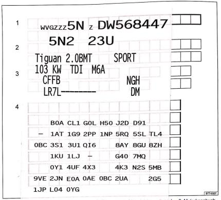
Abb. 1 1. Famzeug-turningerummer, 2. Famzeugtyp, Motorleistung, Getriebe; 3: Motorkennbuchstabe, Getriebekennbuchstabe, Lacknummer, Innenausstattung; 4: Mehr-Ausstattungen, PR-Nummern.
