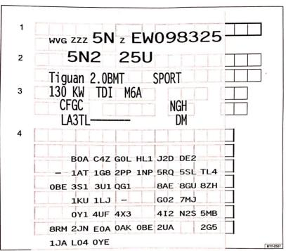
Abb. 1 1: I and eug leartificerungshummer. 2 Fahrabung: Motorleistung, Getriebe; 3: Motorkennbuchstabe, Getriebekennbuchstabe, Getriebekennbuchstabe, Lacknummer, Innenausstattung; 4: Mehr-Ausstattungen, PR-Nummern.
