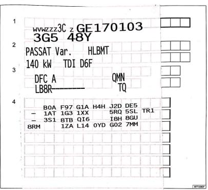
Abb. 1 1: Fahrzeug-Identifizierungenummer; 2: Fahrzeug-yp, Motorieistung, Getnede; 3: Motorkennbuchstabe, Getriebekennbuchstabe, Lacknummer, Innenausstattung; 4: Mehr-Ausstattungen, PR-Nummern.
