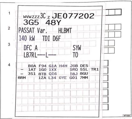
Abb. 1 1: Fanrzeug-identifizierungsnummer; 2: Fahrzeugtyp, Motorleistung, Getriebe; 3: Motorkennbuchstabe, Getriebekennbuchstabe, Lacknummer, Innenausstattung; 4: Mehr-Ausstattungen, PR-Nummern.
