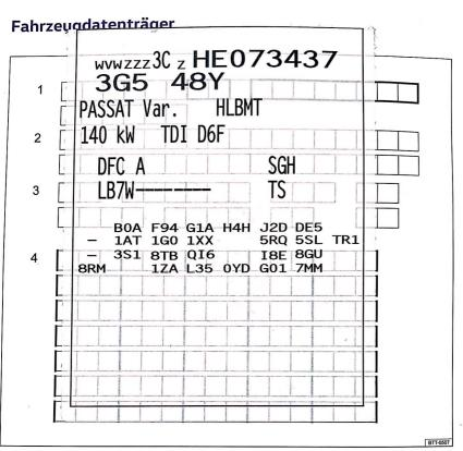
Abb. 1 1: Fahrzeug-Identifizierungsnummer; 2: Fahrzeugtyp, Motorleistung, Getriebe; 3: Motorkennbuchstabe, Getriebekennbuchstabe, Lacknummer, Innenausstattung: 4: Mehr-Ausstattungen, PR-Nummern,
