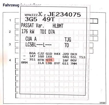
Abb. 1: Fahrzeug-Identifizierungsnummer; 2: Fahrzeugtyp, Motorleistung, Getriebe; 3: Motorkennbuchstabe, Getriebekennbuchstabe, Lacknummer, Innenausstattung; 4: Mehr-Ausstattungen, PR-Nummern.
