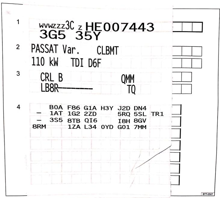
Abb. 1: Fanrzeug-Igentifizierungsnummer; 2: Fanrzeugtyp, Motorleistung, Getriebe; 3: Motorkennbuchstabe, Getriebekennbuchstabe, Lacknummer, Innenausstattung; 4: Mehr-Ausstattungen, PR-Nummern.
