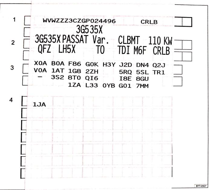
Abb. 1 1: Fahrzeug-Identifizierungsnummer, Z. Fahrzeugtyp, Motoneistung, Gethece, 3: Motorkennbuchtabe, Getriebekennbuchstabe, Lacknummer, Innenausstattung; 4: Mehr-Ausstattungen, PR-Nummern.
