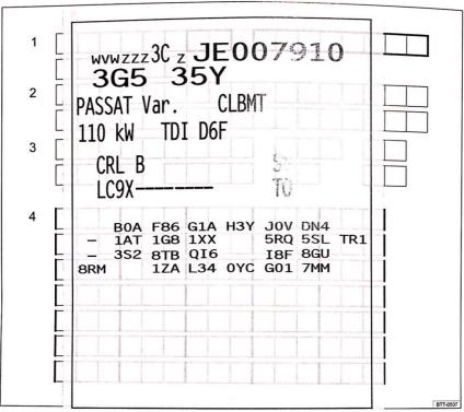
Abb. 1 1: Fahr, eug-Identifizierungsnummer, 2. Fahrzeugtyp, Motorleistung, Getriebe; 3. Motorkennbuchstabe, Getriebekennbuchstabe, Lacknummer, Innenausstattung; 4: Mehr-Ausstattungen, PR-Nummern.
