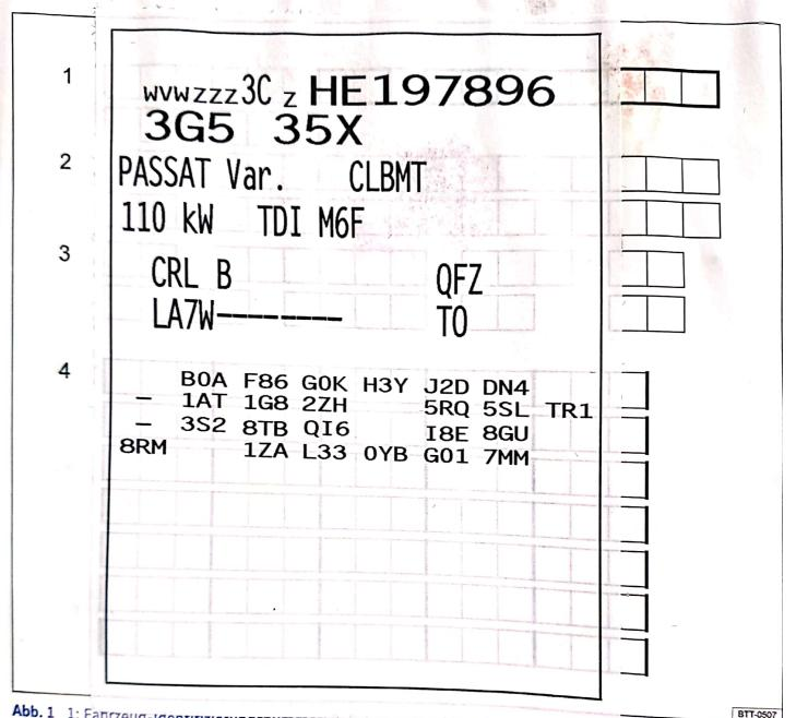
Abb. 1 1: Fanrzeug-Identifizierungsnummer; z: Fanrzeugtyp, Motorieistung, Getriebe; 3: Motorkennbuchsta-BTT-0507 be, Getriebekennbuchstabe, Lacknummer, Innenausstattung; 4: Mehr-Ausstattungen, PR-Nummern.
