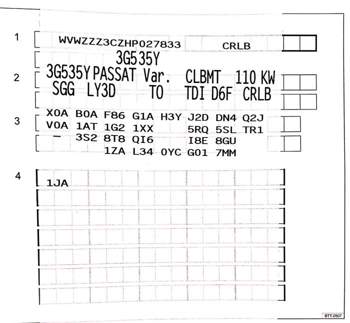
Abb. 1 1: Fahrzeug-Identifizierungsnummer, 2: Fahrzeugtyp, Hotorielstung, Getriebe; 3: Motorkennbuchstabe, Getriebekennbuchstabe, Lacknummer, Innenausstattung; 4: Mehr-Ausstattungen, PR-Nummern.
