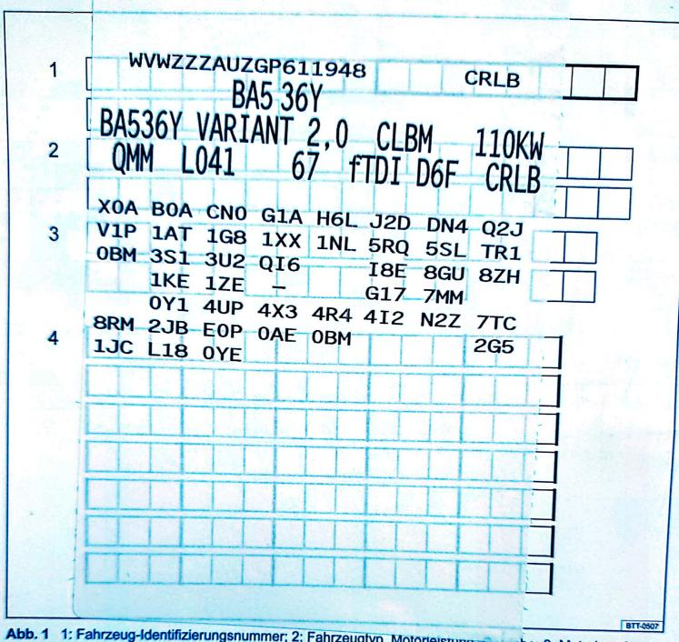
Abb. 1 1: Fahrzeug-Identifizierungsnummer; 2: Fahrzeugtyp, Motorieistung, Getnebe; 3: Motorkennbuchstabe, Getriebekennbuchstabe, Lacknummer, Innenausstattung; 4: Mehr-Ausstattungen, PR-Nummern.
