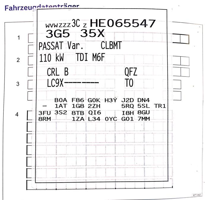
Abb. 1 1: Fahrzeug-Identifizierungsnummer; 2: Fahrzeugtyp, Motorleistung, Getriebe; 3: Motorkennbuchstabe, Getriebekennbuchstabe, Lacknummer, Innenausstattung; 4: Mehr-Ausstattungen, PR-Nummern.
