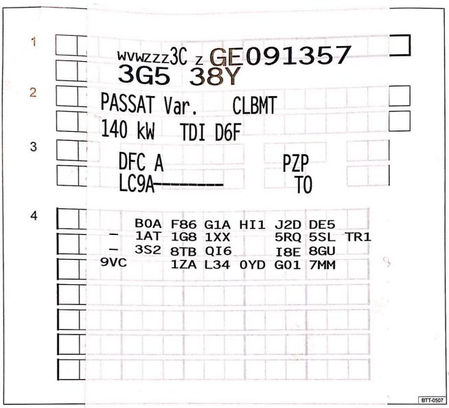
**Abb. 1** 1: Fahrzeug-Identifizierungsnummer, z. Fahrzeugtyp, wotoneistung, Getriebe, S. wotorkennbuchstabe, Getriebekennbuchstabe, Lacknummer, Innenausstattung; 4: Mehr-Ausstattungen, PR-Nummern.
