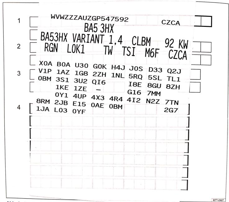
Abb. 1 1: Fahrzeug-Identifizierungsnummer; 2: Fahrzeugtyp, Motorieistung, Gemobe; 3: Motorkennbuchstabe, Getriebekennbuchstabe, Lacknummer, Innenausstattung; 4: Mehr-Ausstattungen, PR-Nummern.
