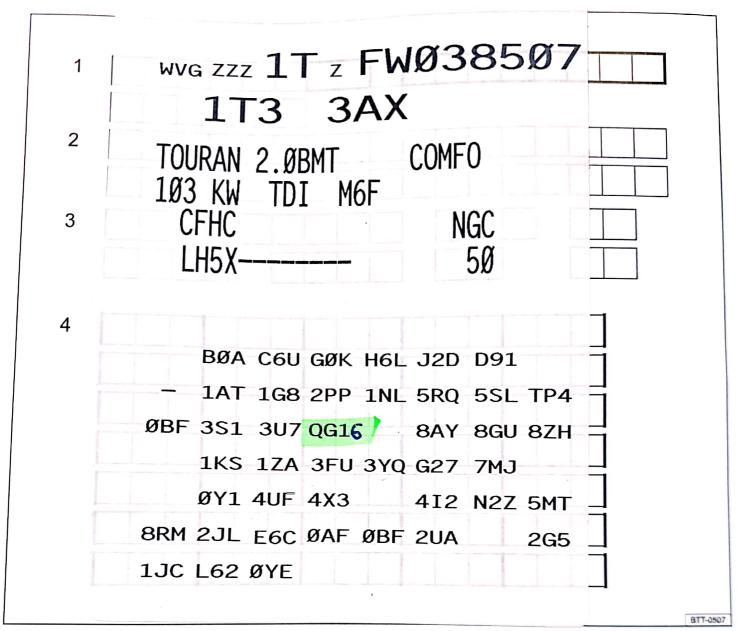
**Abb. 1** 1: Fahrzeug-Identifizierungsnummer; 2: Fahrzeugtyp, Motorleistung, Getriebe; 3: Motorkennbuchstabe, Getriebekennbuchstabe, Lacknummer, Innenausstattung; 4: Mehr-Ausstattungen, PR-Nummern.
