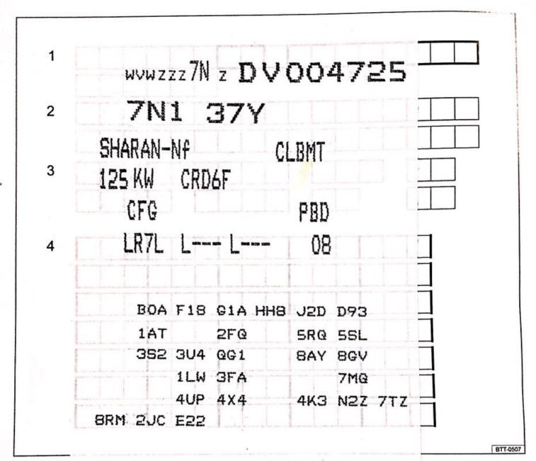
Abb. 1 1: F 1DO 48C BIP USA 1N3 3PD 4A3 BN3 9; 3: Motorkennbuchstabe, Getriebekennbuchstabe, Lacknummer, Innenausstattung; 4: Menr-Ausstattungen, PR-Nummern.
